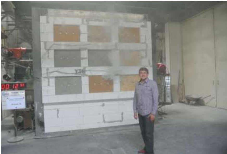
Výzkumný projekt – zkouška požární odolnosti stavebních konstrukcí na bázi dřeva – 6/2014
